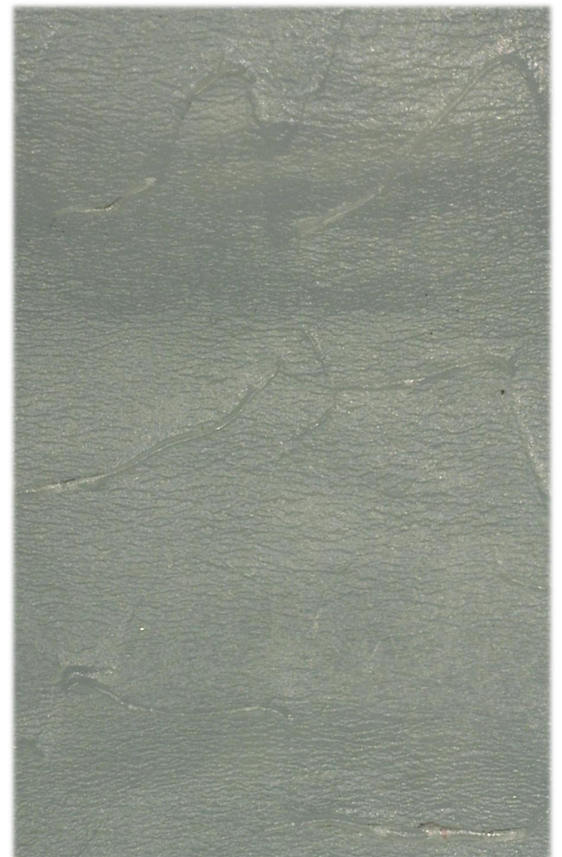
▪Oberflächlicher Defekt eines HD-PE
