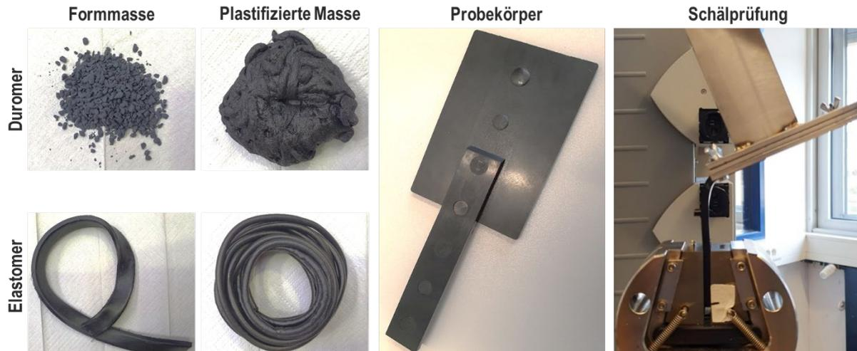
Darstellung der Herstellung eines 2K-Verbundprobekörpers aus rieselfähigem Duromer und Elastomer und Prüfung des Schälwiderstandes in einer Zugprüfmaschine
