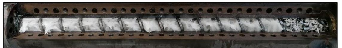
Abb.: Klappzylinder zur Entnahme von Proben entlang des Plastifizierwegs
