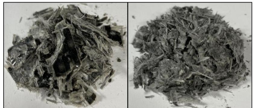
Abb.: Mahlgut mit PA6-15mm (links) und PP-10mm (rechts) Matrix
