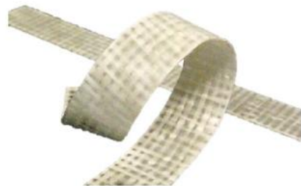
Abb.: Verstärkungspatch aus einer TPE-S Matrix
